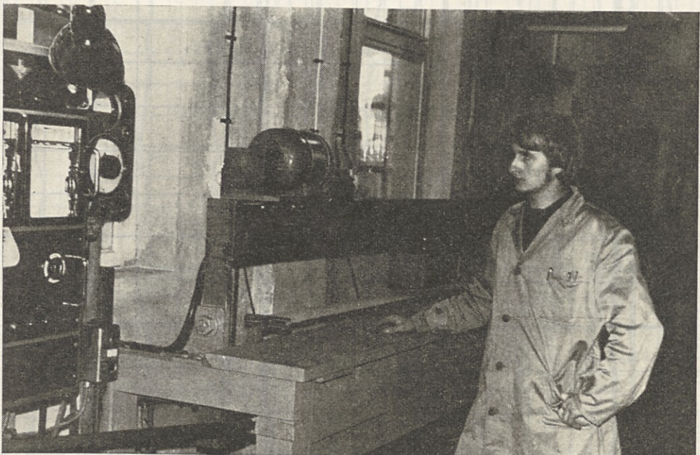
Obratni laborant Franc Košir kontrolira enakomernost teže po širini papirnega traku
