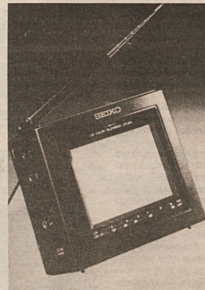
To je Seikov barvni televizor LCD z zaslonom 3.3 palca in enkratno definicijo slike (82.368 pixel)
