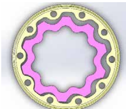
Tribološki par 4: rotorjev obroč-ohišje.
