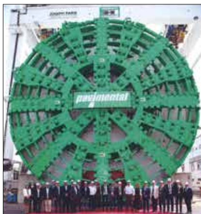
Tunelski vrtalni stroj s premerom 15,87 metrov za predor Santa Lucia skozi Apenine v Italiji je največji v Evropi
