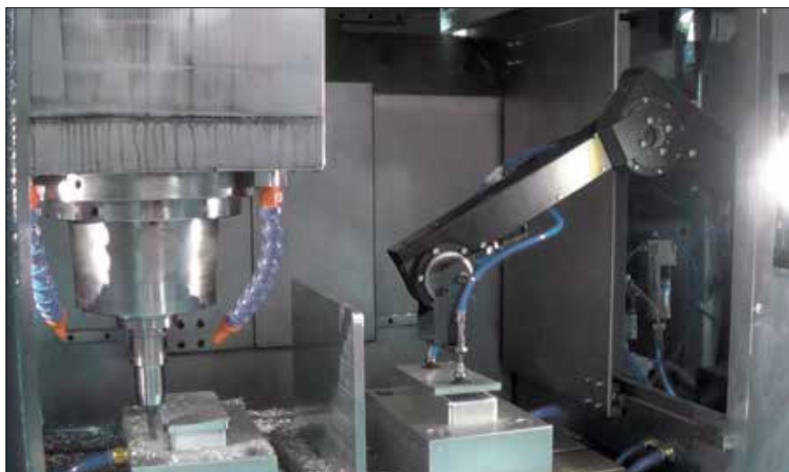
Slika 6. ROBOLINK® D na stroju za obdelavo okrova
