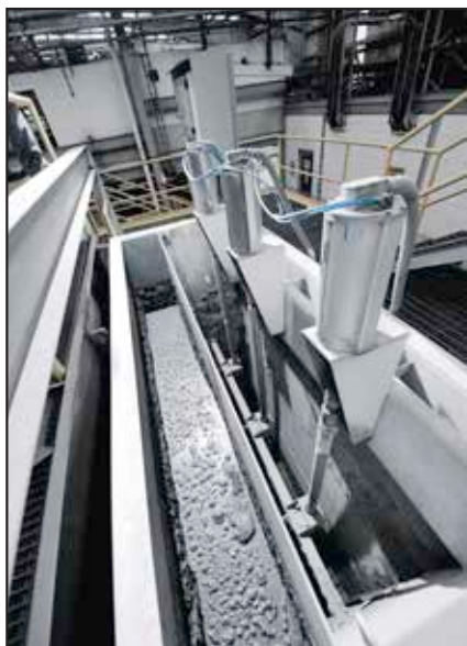
Slika 8. Kompaktni in robustno zaščiteni pnevmatični linearni pogoni z vgrajenim krmilnikom položaja in dajalnikom pomika DFPI za regulacijo zapornih ventilov v flotacijski kadi. Po štirih letih uporabe še brez vzdrževanja in zaustavitve. (Foto: Festo AG & Co. KG)
