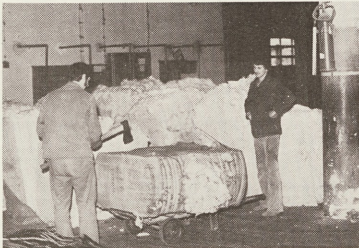
Stari način sekanja obročov – kovinski delec lahko kaj hitro zaide med predivo – uporabljajte zaščito!
