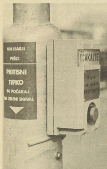
Semaforska naprava s samopostrežbo, znana pod oznako MSKE 40/10
