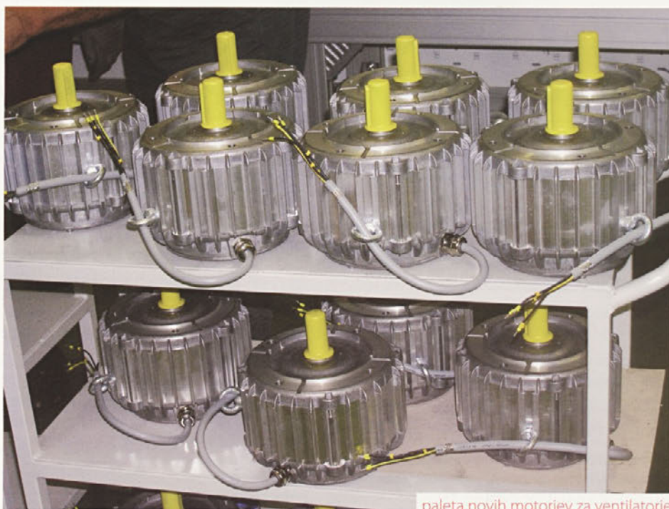
paleta novih motorjev za ventilatorje
