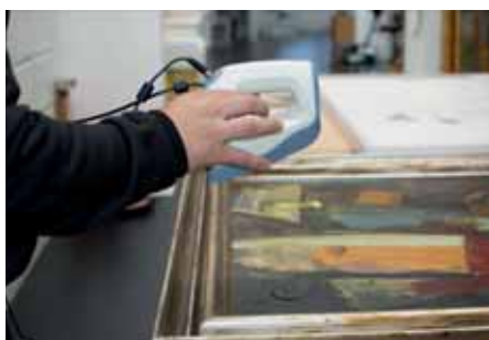
Slika 5: Kopiranje detajlov s 3D-tehnologijami (zajem s skenerjem, 3D-tisk, UV-kapljični tisk fotografije slike na predhodno 3D-tiskani reliefni detajl)
