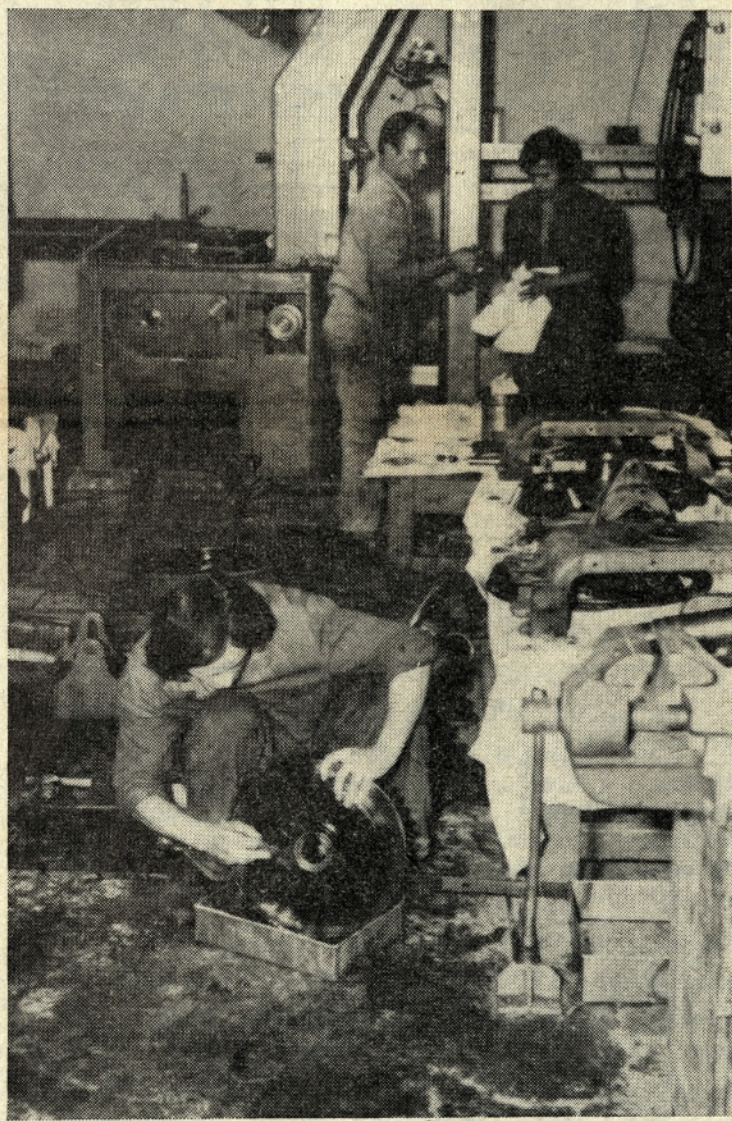
Med kolektivnim dopustom plemenitilnice I: vzdrževalci pri remontu razpenjalno sušilnega stroja.
