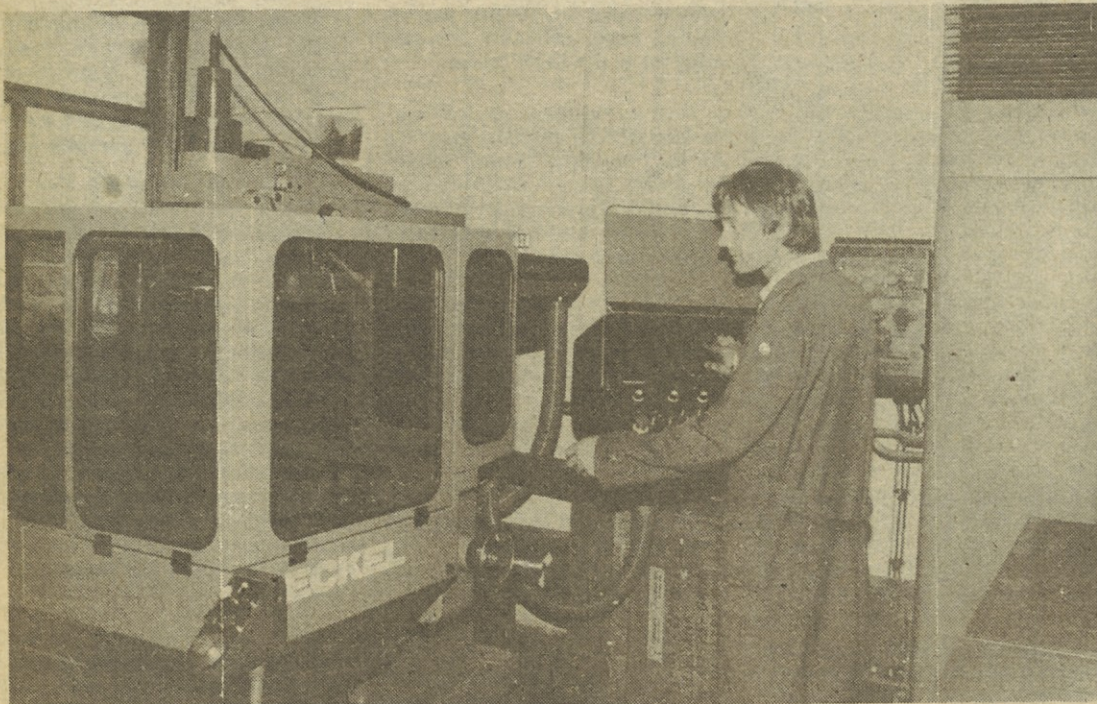
Numerično krmiljeni rezkalni stroj DECKEL FP 4 NC
