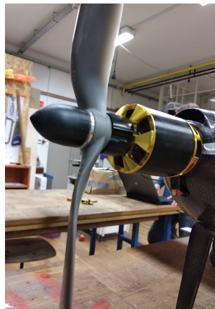
Skoraj 3-kW Scorpionov pogonski motor je zagotavljal 70 N statičnega potiska.
