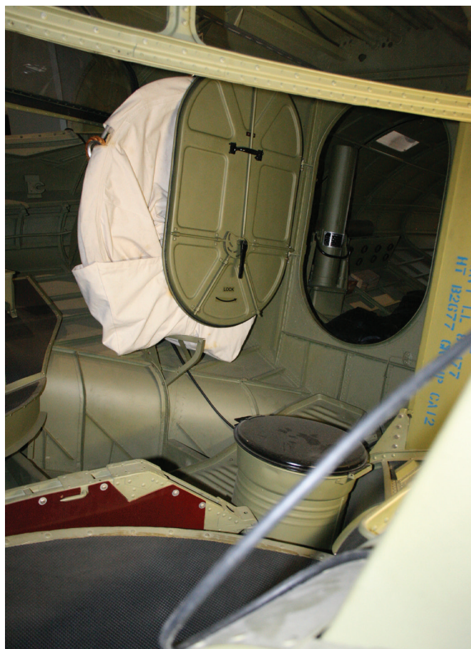
Notranja stena predela s strojničnimi gnezdi in toaletnim prostorom (Foto: Mitja Maruško)
