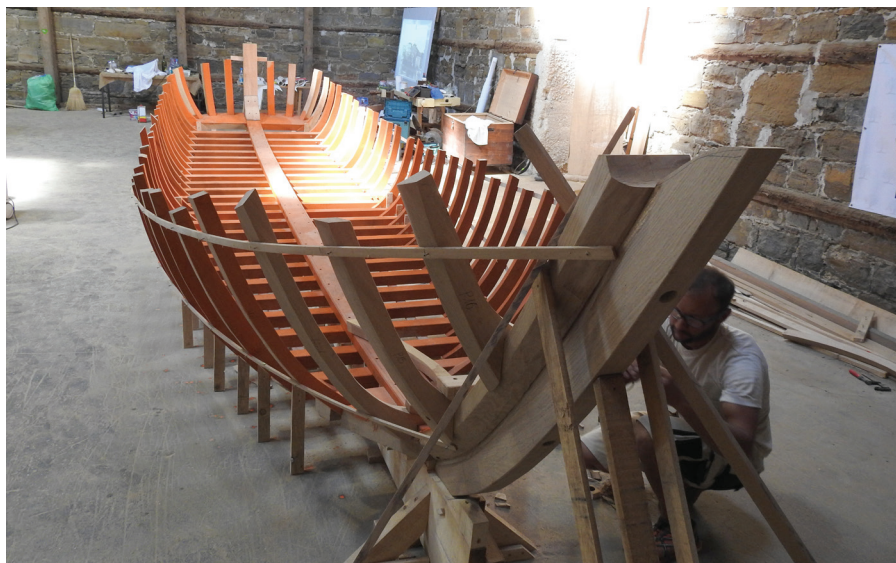
Kristjan Kerin se ukvarja s končno obdelavo reber. Ta so izdelana iz hrastovine, les zanje pa so dobili v Posavju. (Vir: Pomorski muzej Sergej Mašera Piran, foto: Vinko Oblak)
