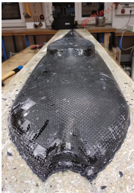
Trup med odstranjevanjem iz kalupa
