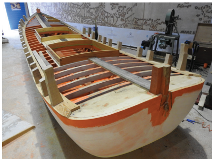
Istrski topo v zaključni fazi gradnje. Lepo se vidi široko zaobljen krmni del. Ekipo Tomija Sinožića je za palubo uporabila macesnov les. (Vir: Pomorski muzej Sergej Mašera Piran)
