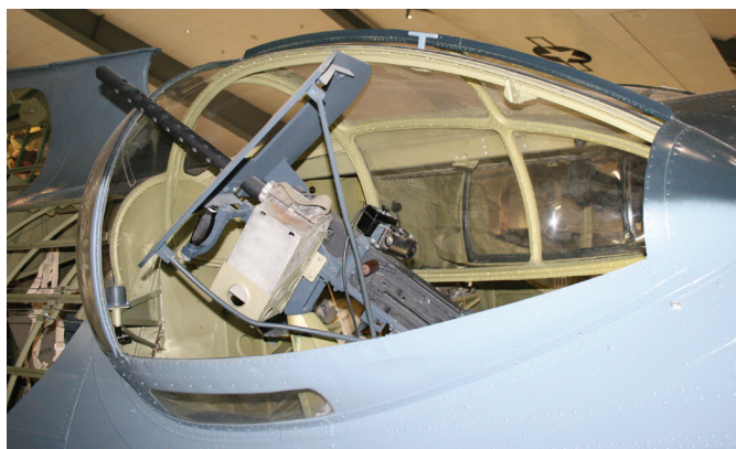
Bočno strojnično gnezdo in steklena kupola. Na fotografiji je dobro viden delno zastekljen spodnji del kupole, ki ga prozorni del v maketi ne prikazuje. (Foto: Mitja Maruško)
