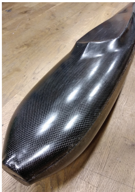
Izdelan trup, odstranjen iz kalupa in očiščen
