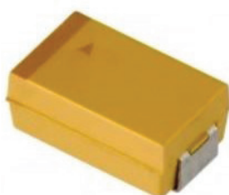
Tantalni kondenzator (SMD), črta označuje pozitivni priključek kondenzatorja.
