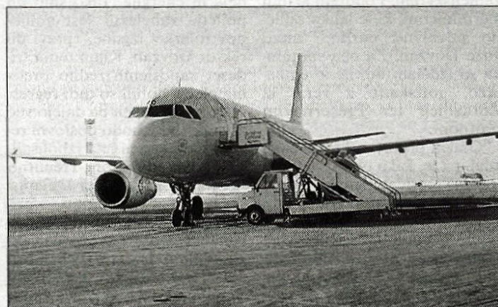
Ko letalo pristane, mu najprej pripeljejo posebne premične stopnice za izkrcanje potnikov, potem pa se mu približajo vozila za oskrbo s pitno vodo, za praznjenje toaletnih zbiralnikov na letalu, čiščenje letala...
