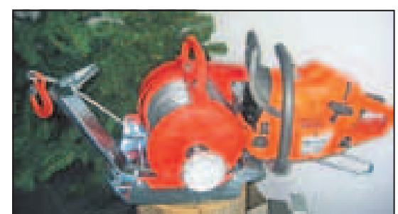
Vitel na motorci, ki ga uporabljamo tam, kjer ni cest, ima moč potega do 1.800 kg.
