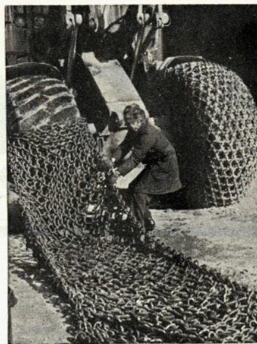
Po dolgi razvojni dobi nam je uspelo ob vsesplošni »podpori« izdelati največje zaščitne verige Mehanizirana montaža zaščitnih verig
