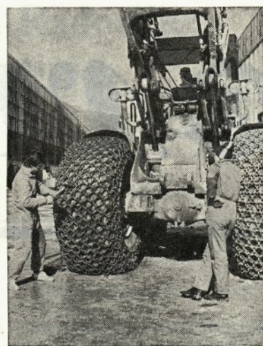
Po dolgi razvojni dobi nam je uspelo ob vsesplošni »podpori« izdelati največje zaščitne verige Mehanizirana montaža zaščitnih verig
