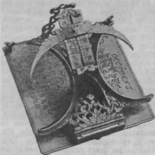
Bagata okrašena, pozlačena ekvatorska sončna ura. Augsburg, 1720. Na spodnji plošči večni koledar
