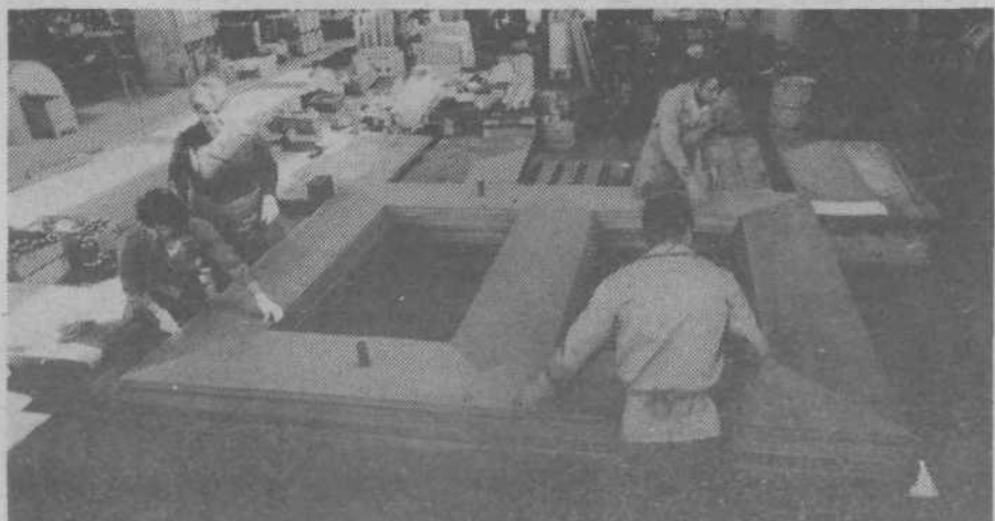
V Energoinvestu na Črnučah bodo letos za 30% presegl lanski fizični obseg proizvodnje. Na sliki: postopek zlaganja jedra transformatorja tip RT 31,5/31,5/21 MVA 110/36, 75/21 kV za Prištino. Jedro je napravljeno iz 11.400 kosov pločevine vrste hipersil m 4 (iz uvoza) debeline 0,3 milimetra in tehta 18.400 kilogramov.
