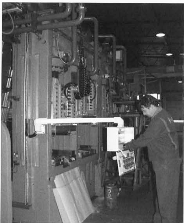
Štiripostajna hidravlična stiskalnica za preoblikovanje koncev listov
