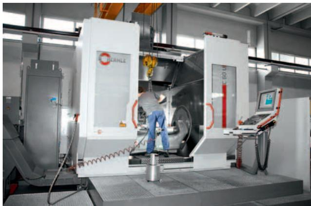
› Vpenjalni sistem z ničelno točko omogoča zamenjavo obdelovanca v nekaj minutah.
