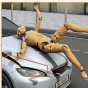
**30** Preizkušanje ter meritve sistema aktivne varnosti pešca s 3D optično merilno tehniko
