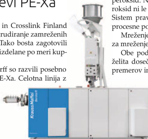
sestavine pomešajo, polietilenski granulat vpije tekoči peroksid. Nastane izjemno homogena mešanica, saj peroksid ni le na zunanosti zrn, ampak tudi znotraj le-teh. Sistem prav tako zagotavlja zanesljive in enakomerne procesne pogoje, tj. visoko kakovost izdelkov.
