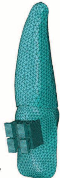
› Slika 3: Končni elementi na zobu stranski sekalec, PDL in nosilcu
