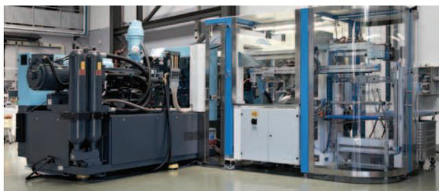
Najmanjši model serije IntElect, IntElect 50-45 z zapiralno silo 500 kN, je na sejmu izdeloval kontrolne gume slušnih aparatov s premerom 3,5 mm in težo 10 mg. Mali kosi postavljajo visoke standarde kakovosti in zahtevajo absolutno ponovljivost. Natančna in občutljiva pogonska tehnologija stroja in sistem odstranjevanja kosov, integriran v stroj, te zahteve tudi izpolnjujeta.
