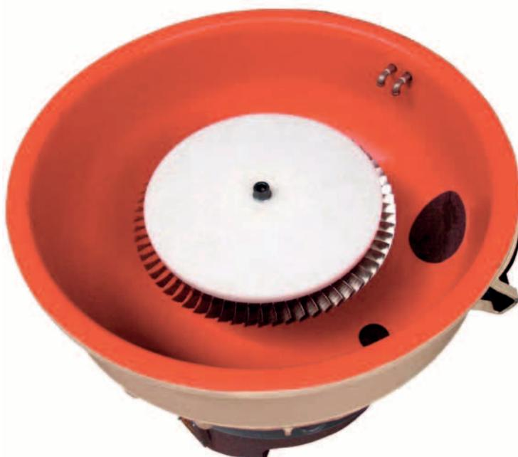
Rösler ponuja posebne rotacijske vibratorje za obdelavo velikih komponent, ki se običajno proizvajajo v majhnih serijah. Komponente se pritrdijo na vibracijsko delovno posodo, s čimer se občutno poveča intenzivnost procesa obdelave.
