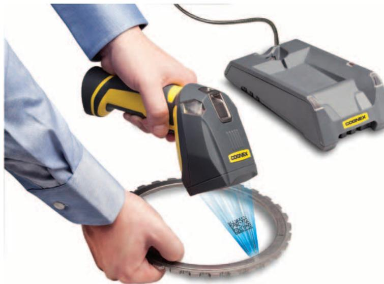
vost, metodo tiska ali površino. Serija DataMan 8000 ponuja tudi fokusiranje s tehnologijo tekočinskih leč (angl. *liquid lens*), ki omogočajo branje manjših površinskih (2D) oznak na delu DPM (angl. *direct part marks*), pa tudi dolgih (1D) črtnih kod z enim čitalnikom.
