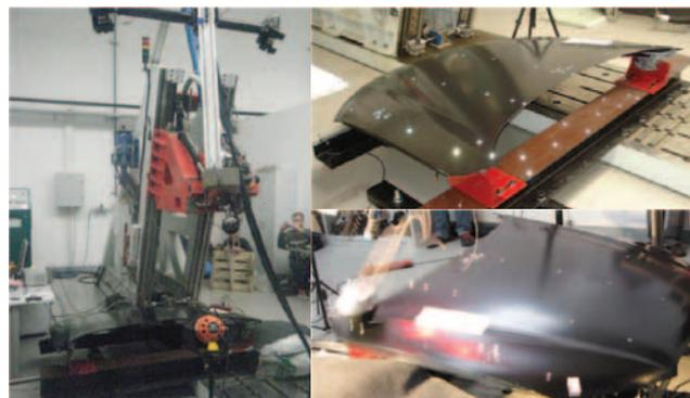
PULSE proizvajalca Bruel&Kjaer, s katerim upravljavec tvori dva sprožilna signala, ki prek namensko izdelanega vmesnika z ustreznimi časovnimi zamiki prožita naslednje sklope: DSD HyperG Actuator (naprava za pospeševanje modela glave pešca v pokrov motorja), snemanje stereokamer sistema GOM Pontos HS za meritve deformacij, snemanje s kamero i-Speed (velike hitrosti).
