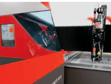
» Konzolna izvedba stroja za rezanje z vodnim curkom z dvema rezalnima glavama.
