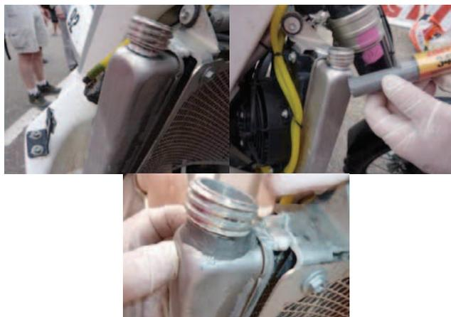
» Popravilo zamaška hladilnika # - Med padcem francoskega motorista je hladilnik motorja zadel ob skalo. V bivaku so čarliji popravili razpoke, ki so nastale na aluminijastem delu tik pod zamaškom. Uporabili so kovinsko polnjen epoksi Loctite® 3463. Čez pet minut je bil motor že pripravljen na nove podvige.
