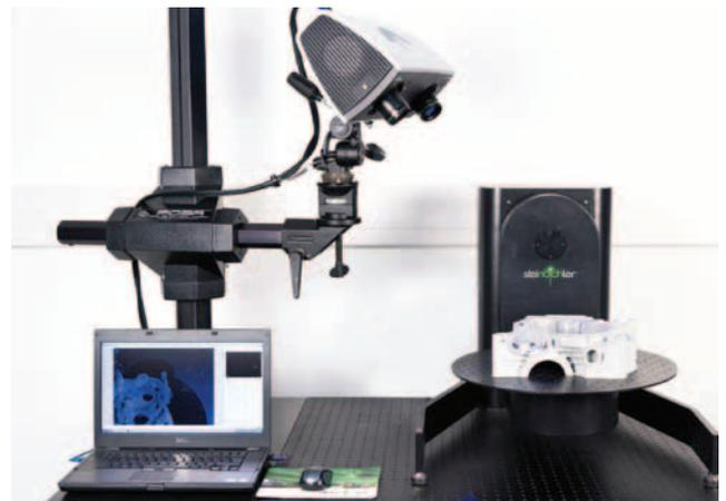
» Prenosni optični merilni sistem s strukturirano osvetlitvijo CO-MET-L3D podjetja Steinbichler odlikuje visoka natančnost meritev tudi v zahtevnih delovnih razmerah. (Foto: Steinbichler)
