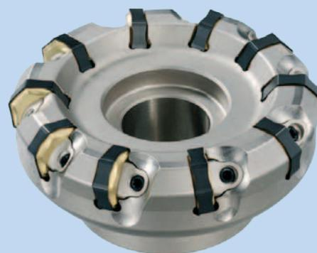
Rezkalne glave **AHX640W** od premera 80 do 315 mm z izmenljivimi ploščicami, ki imajo 14 rezalnih robov. Omogočajo grobo in fino rezkanje do globine rezkanja 6 mm. Rezkanje z wiper ploščicami nadomesti brušenje.
