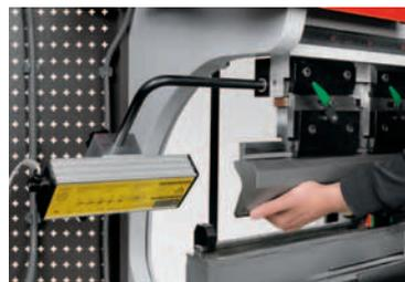
» Rokovanje z orodnim sistemom pri stiskalnici Xcel 50 je enostavno. Laserska zaščita stroja (na sliki levo) skrbi za varnost operaterja stroja.
