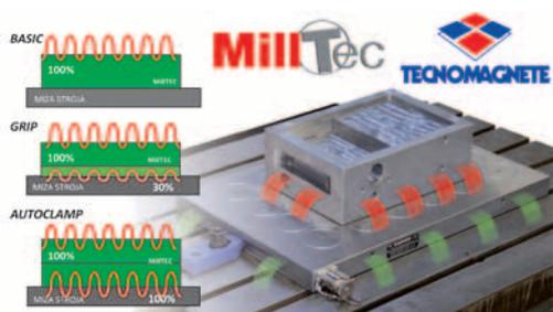
Tecnomagnete je izdelal nove magnetne mize za rezkanje Mill Tec, ki so na voljo v treh izvedbah. Prva je klasična, BASIC, ki ima samo magnetno površino za vpetje obdelovanca (brez magnetnega vpetja na mizo stroja). Višina mize je 60 mm. Druga izvedba
