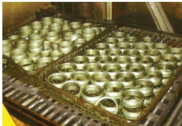
➤ Žarjeni ležajni obroči iz jekla 100 Cr6
