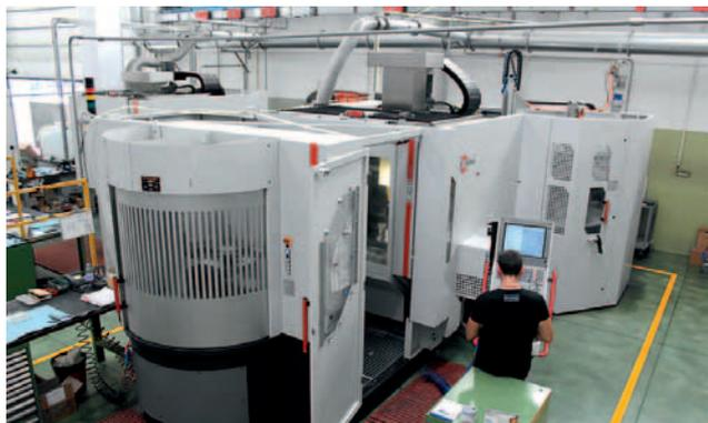
» Petosni visokozmogljivi obdelovalni center C 40 UP s sprednjim paletnim menjalnim sistemom PW 160
