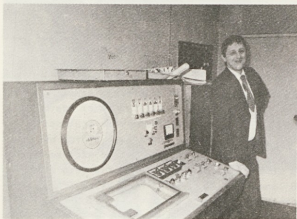
"Libelin" komandni pult z elektroniko predstavlja "možganski center" celotne mešalnice.
