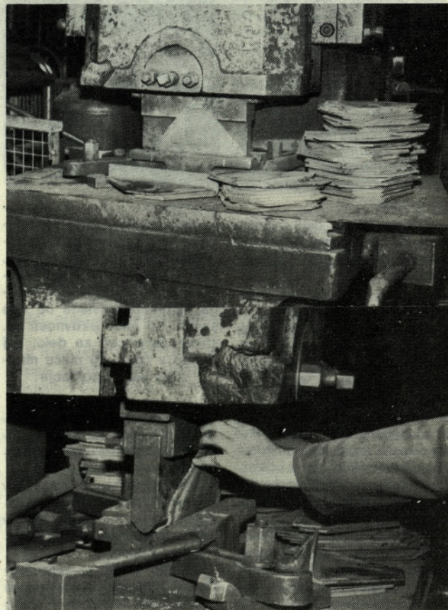
V TOZD Odpreskov in avtokoles se je 26. marca 1987 ob 11. uri poškodoval delavec G. B. Pri krivljenju kotnikov za prečko na stiskalnici je le-ta ponovila delovni hod in pri tem delavcu stisnila drugi in tretji prst leve roke med kotnik in pah orodja
