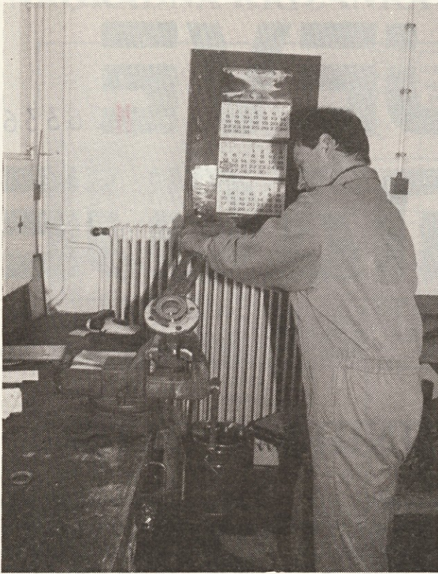
Vzdrževalec Marjan popravlja poliestrski cevovod za skladišče smol...
