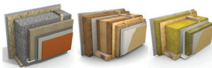
Slika 4: Stenski elementi pasivnih hiš, od leve proti desni: lesena okvirna konstrukcija z I-profilii in toplotno izolacijo iz celuloznih vlaken (Sistem Lumar IG); panelni konstrukcijski sistem s toplotno izolacijo iz lesnih vlaken (sistem Marles hiše Maribor); panelni konstrukcijski sistem s toplotno izolacijo iz mineralne volne (sistem Marles hiše Maribor).
