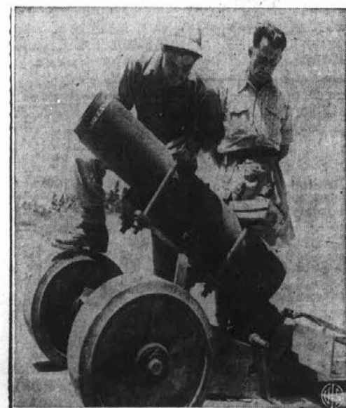
Top domačega izdelka. — Dva židovska vojaka si ogledujeta 8 palčni top domačega izdelka, ki so ga zaplenili Arabcem v bojih pri Tel Avivu. Top so izdelali arabski železniški delavci; prižge se ga na ta način, da se na spodnjem delu vrže v cev prižgano užgalico.
