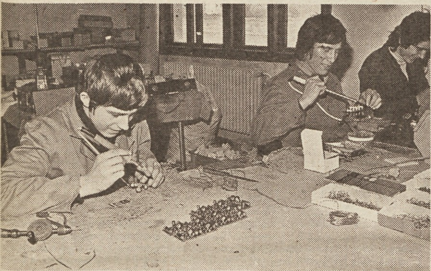
Spajkanje ploščic tiskanega vezja in drugih elementov.
