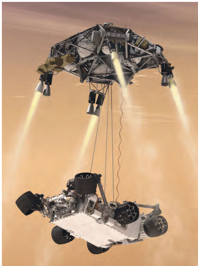
Shematski prikaz raketnega pogona in uporabe nebesnega dvigala. Sonda je nežno spuščena na površje s tremi izjemno močnimi najlonskimi vrvmi. Ko se sonda dotakne površja, se raketni pogon loči in oddalji od nje ter pade na površje. Foto: NASA/JPL-Caltech.
