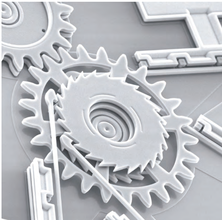
Mikroskopska slika mikromehanične naprave. Zobniki dopuščajo vrtenje v eno smer, preprečujejo pa vrtenje v drugo.
