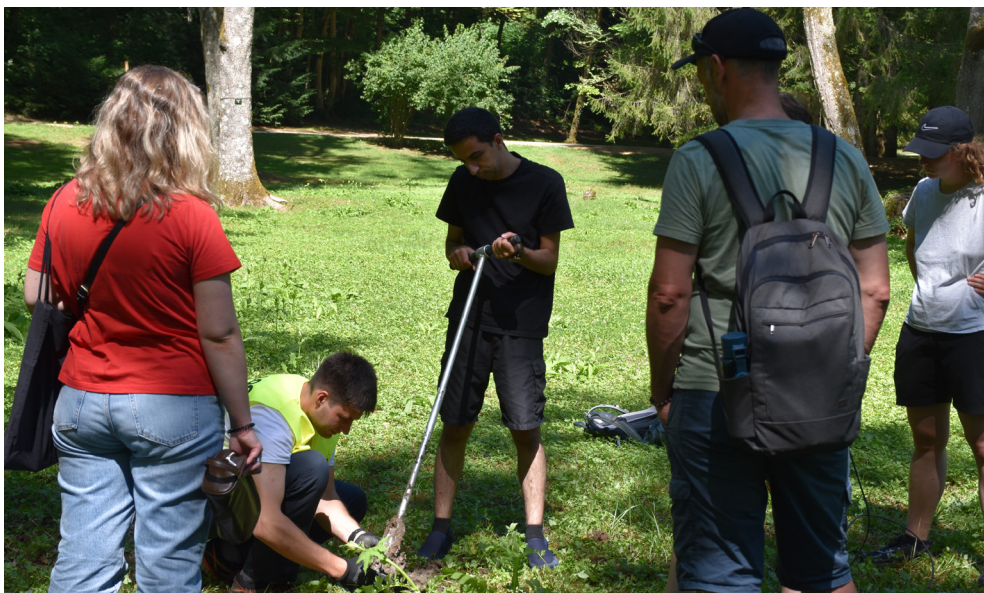
Sl. 2. Terenske vaje iz meritev toplotne prevodnosti tal.
