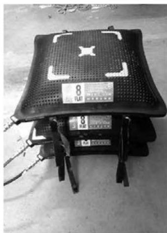
Pnevmatske blazine za premagovanje težjih bremen
