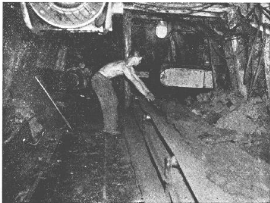
Nakladanje premoga na zbirni transportni trak
