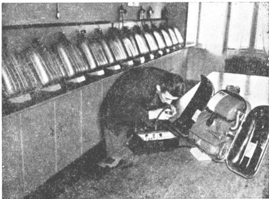
Rudnik Velenje ima tudi najmodernejšo rešilno postajo — kot vojaki stojijo Drägerji — »Custos Lojzek« preizkuša Dräger aparat
