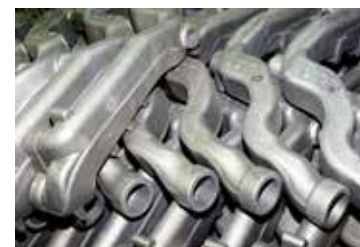
Ulitke WB6 od leta 2013 obdelujemo tudi s CNC-stroji, sprva (od leta 2006) smo jih proizvajali le kot surovce.
