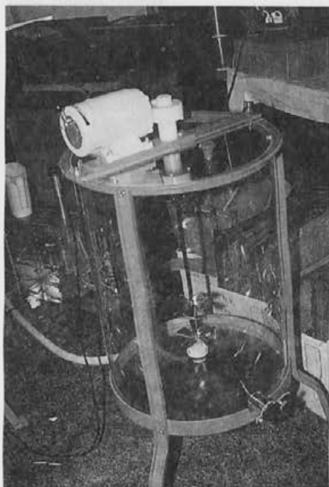
Točilo na električni pogon, prirejeno za izdelavo kremnega medu z dodanim navojnim mešalom. Foto: J. Mihelič
