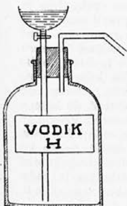
Če odpremo pipico pod lijakom, bo voda tekla v steklenico in iz nje iztisnila vodik
