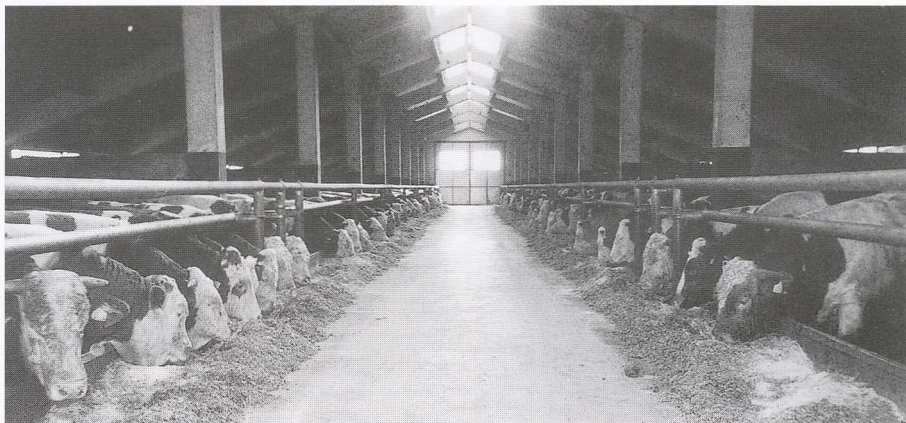
Sodoben goveji hlev omogoča, da ima živina neprestano dostop do krme ter da se v boksih prosto giblje. Hlev po sistemu tlačnega gnoja, ko živali ob obodnih stenah same potiskajo gnoj na plano, je tudi v slovenskih razmerah eden redkih.
