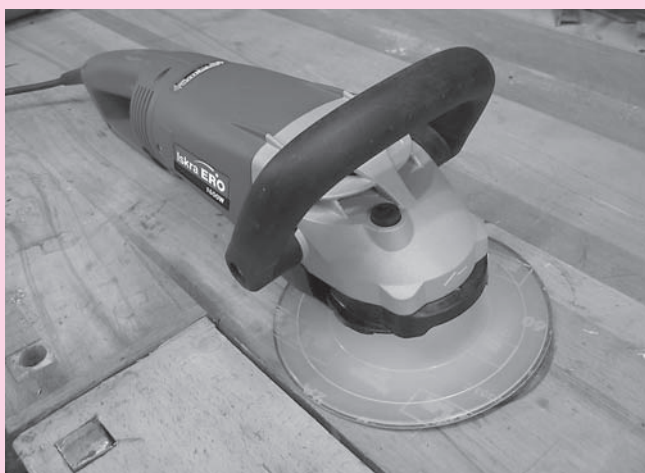
□ Slika 2. Ročaj s stikalom lahko enostavno in hitro obrnemo po potrebi za 180 stopinj, na sliki je stroj pripravljen za vertikalno brušenje površin na levi strani
