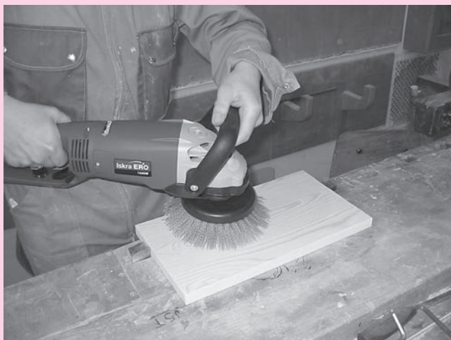
□ Slika 3. Ščetkanje površine masivnega lesa smreke
