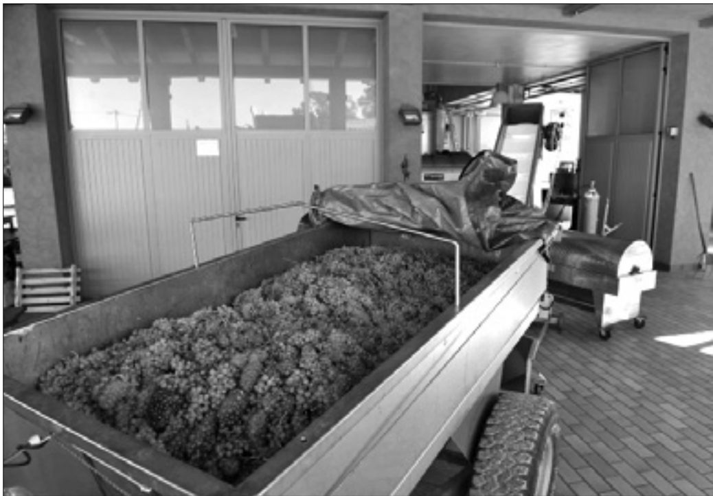
Levo prikolica z grozdem, spodaj prehod iz prikolic v pecljalnik
