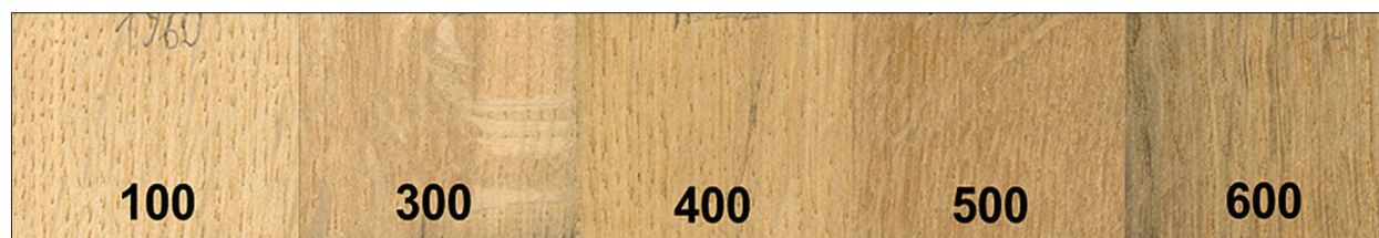
Slika 3. Videz tipičnih hrastovih preizkušancev od najmlajše do najstarejše starostne skupine 100 – 600 let. Figure 3. Appearance of typical oak specimens sorted from the youngest to the oldest (age groups 100 – 600)
