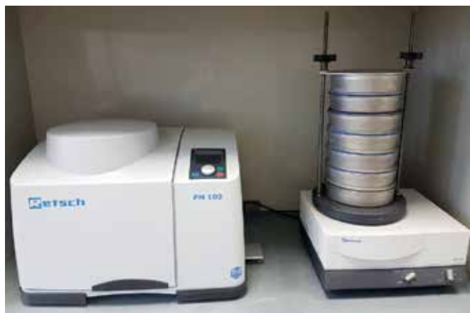
Slika 2: Planetarni kroglični mlin in sejalec s stavkom sit
