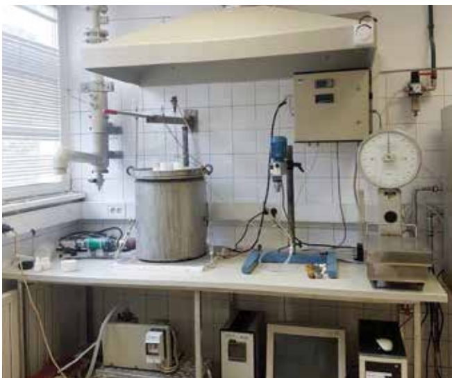
Slika 4: Pilotna razklopna naprava (reaktor z grelcem zraka, pokrov reaktorja z nameščenimi temperaturnimi tipali, dimnik s sondo za pretok plinov, napa, parni generator, črpalka, mešalo in tehnica, priključek za zrak, ARM omarica in računalnik).
