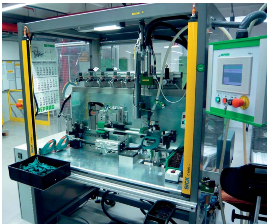
Stroj za sestavljanje in vijachenje teleskopskega držala na sesalniku
