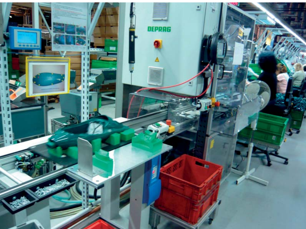
Postaja za sestavljanje ohišja na liniji za sestavljanje sesalnika Kobold 140
