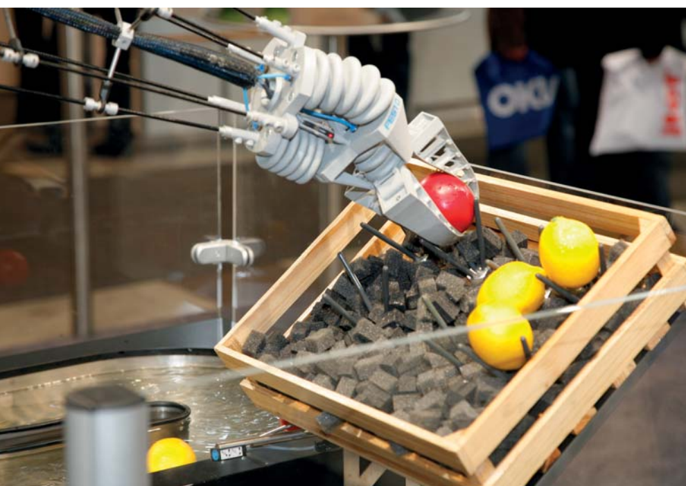
Tudi to je bionika: prijema s plavutnimi prsti (angl. fin gripper) na ultralahkem robotu za prijemanje krhkih ali površinsko občutljivih predmetov podjetja Festo AG (foto: dr. Tomaž Perme)
