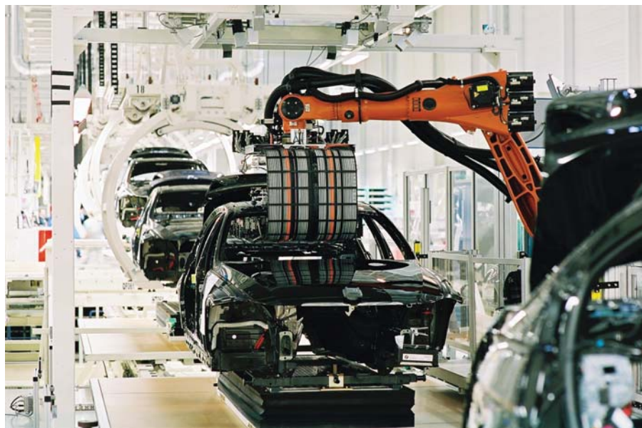
Nameščanje strehe na premikajoči se liniji za sestavljanje
