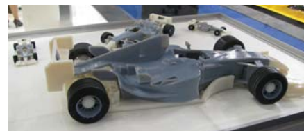
Slika 9. Model bolida Formule, narejen s postopkom PolyJet Matrix (foto: D. Godec)
