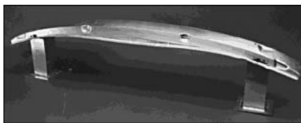
Slika 9: Odbijač avtomobila, izdelan iz kovinske pene [1]
