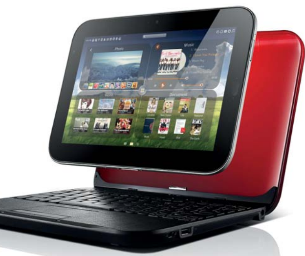
Hibridna tablica: Lenovo IdeaPad U1 Hybrid je sestavljen iz tablice Lenovo LePad, ki se običajno uporablja samostojno, in baze – prenosnika, v kateri tablica postane le »zaslon« standardnega prenosnika s sistemom Windows 7.
