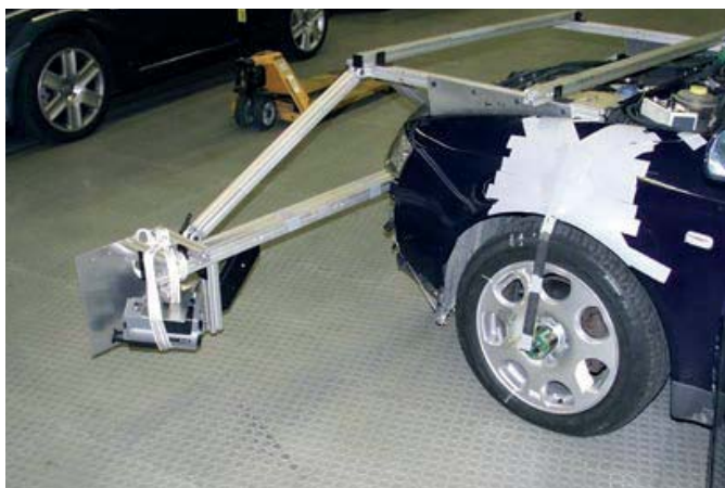
Infrardeča kamera meri kotalni upor in druge značilnosti pnevmatik.
