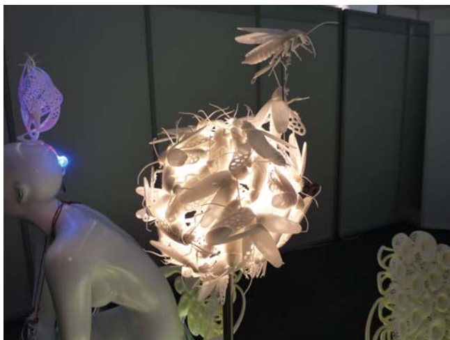
Slika 3: Možnosti uporabe dodajalnih postopkov: a) svetilka v obliki roja žuželk, b) bolid, gnan z akumulatorskimi vrtljivniki Bosch (foto: A. Pilipović, D. Godec)
