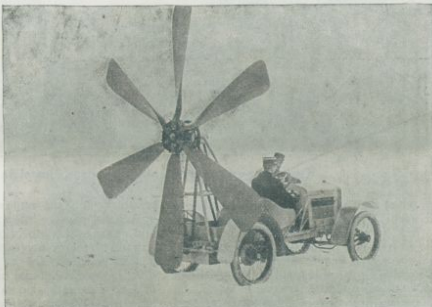
Francoski vojni avtomobil z vijakom. Pri tem avtomobilu ne goni motor koles samih, kot pri navadnih avtomobilih, marveč obrača vijak kakor pri letalih. S tem avtomobilom se baje doseže še večja hitrost in vztrajnost.
