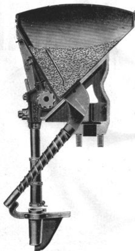
Pod. 32. Sejalni zaboje z okrovom (ohišjem) za razdelitev semena in s pritrjenim lijem za izpraznitev sejalnega zaboja.
