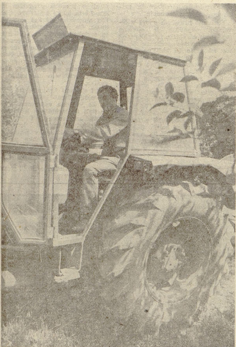
V novih kabinah je traktorist zavarovan pred škodljivimi vplivi škropiv.
