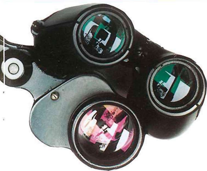
Zgornji daljnogled ima večplastne (MC) prevleke, spodnji pa en sam protiodsevalni sloj. Vidna je razlika v številu in intenziteti odsefov
