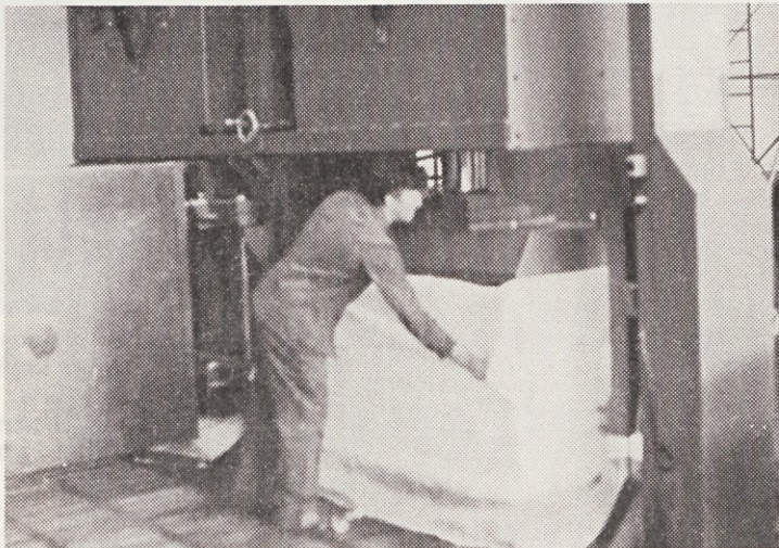
Sodelavec odpira stiskalnico za mešanico vlaken v mešalnici.
