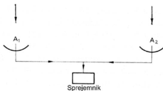
Slika 9: Interferometer z dvema antenama (A1 in A2). Signala obeh anten združimo na sprejemniku.
