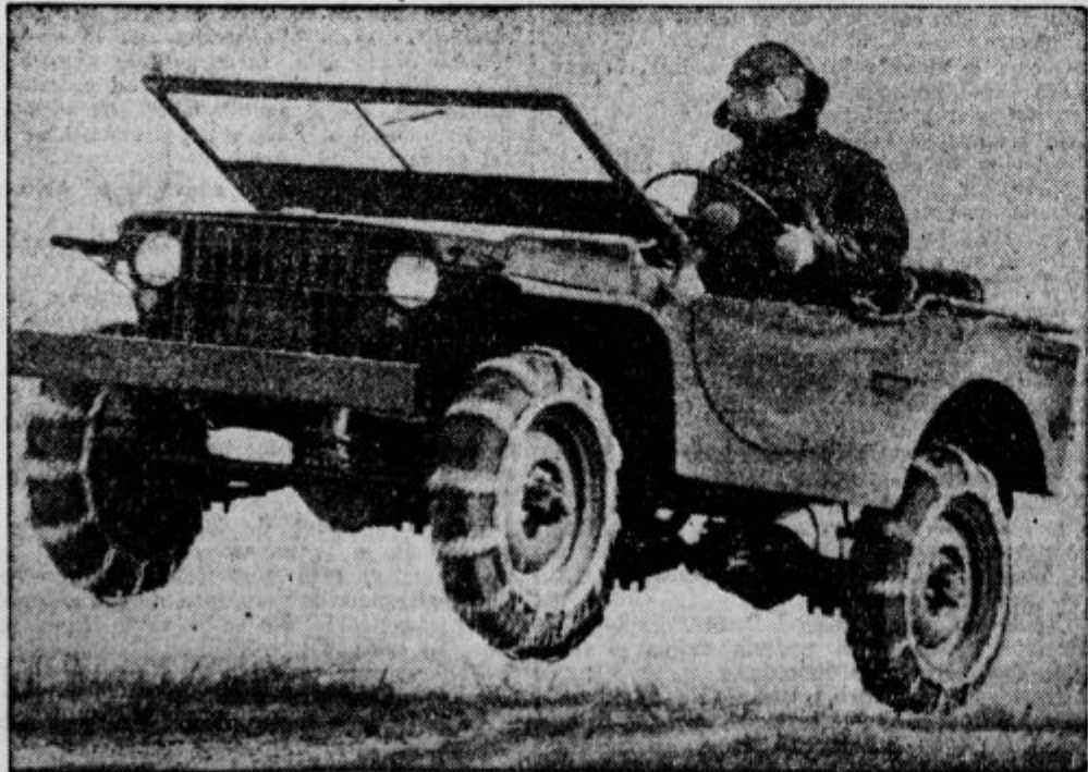
Nov Fordov avtomobil, ki ga je Ford sgradil za ameriško armado, kateri služi za obveščevalno službo. Avto napravi 96 kilometrov na uro ter drvi lahko po strmini, ki znaša 68%.
