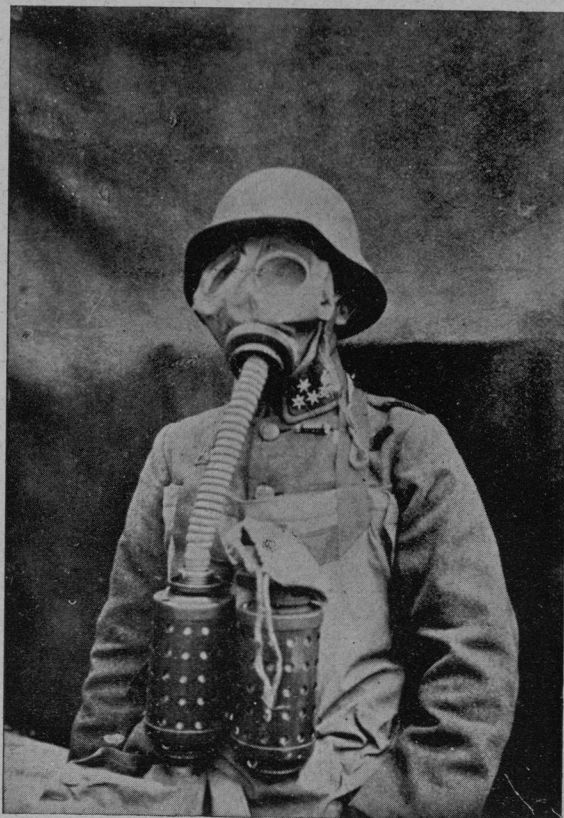
Moderna iznajdba v vojni: Aparat, ki daje zraka kopalcem rogov pri njih težavnem podzemeljskem delu. Mnogokrat se naberejo strupeni plini v rovih, ki kopalce zadušijo. Na trebuhu imajo torej posodo s kisikom, ki ga potom cevi vdihavajo in na obrazu imajo masko proti strupenim plinom.
