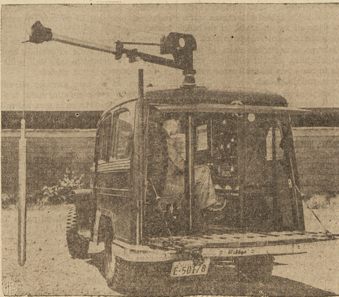
NA LOVU ZA URANOM — Ameriška vlada se trudi, da bi našla nova ležišča urana. Raziskovalci se pri tem delu poslužujejo takozvane "scintillation unit," vgrajene na avtomobil. Priprava, ki jo vidimo na sliki, preiskuje lahko tudi prepade in pečine v globino do 1,000 čevljev.
