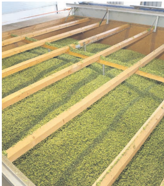
Ko se hmelj posuši na približno 60 stopinjah Celzija, ga s tekočim trakom prepeljejo v shrambo ...
