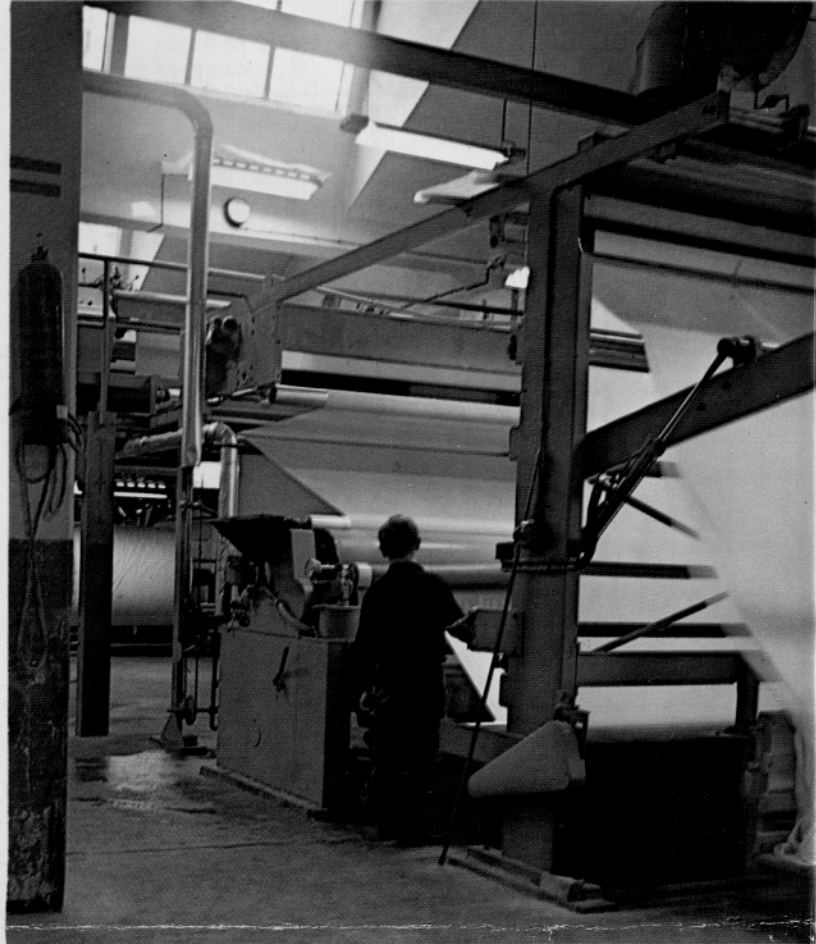
Razpenjalno sušilni stroj ARTOS v oplemenitilnici
