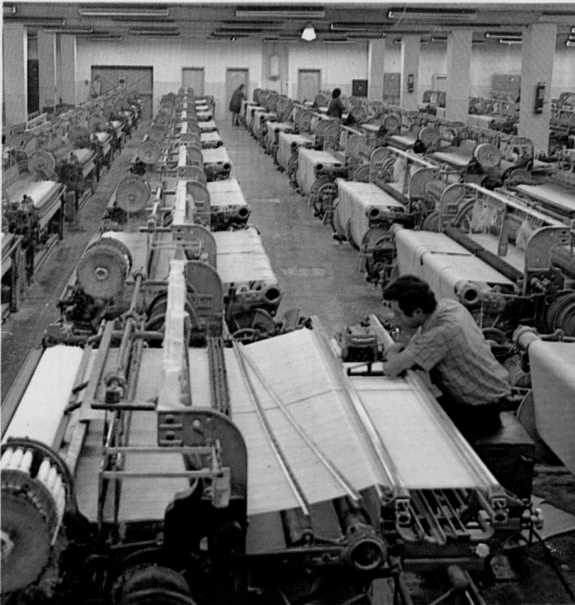
Strojno privezovanje osnove na tkalskih avtomatih KOVO 275
