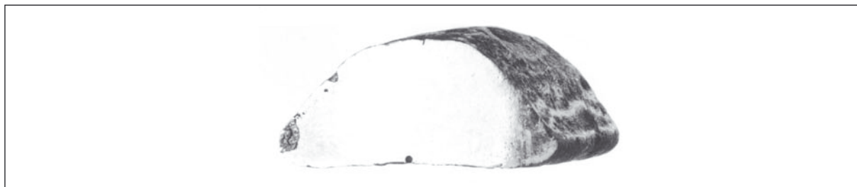
Sl. 9a: Kanalski Vrh. Spolirana, svetleča površina ingota GM 6584, pripravljena za metalografsko analizo.
