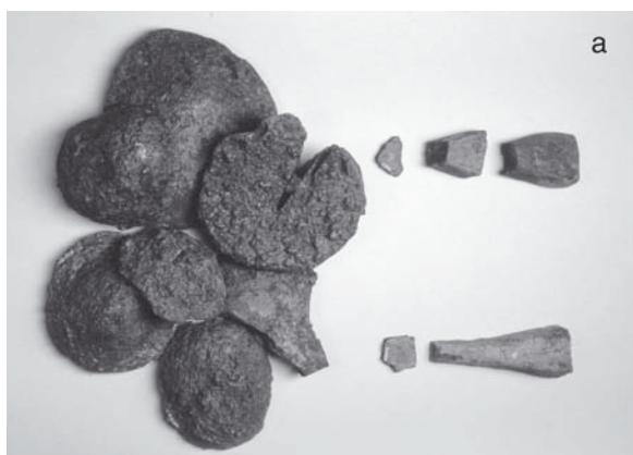
Sl. 16: Dragomelj. Izbor ingotov in pogač, katerih kovina kaže na izvor iz kompleksnih rud. a) z Ni- arzenidi; b) z Ni- in Co- arzenidi (foto Tomaž Lauko).
