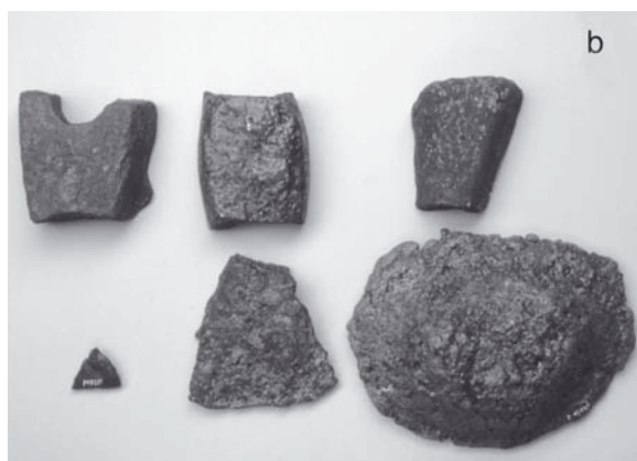
Sl. 16: Dragomelj. Izbor ingotov in pogač, katerih kovina kaže na izvor iz kompleksnih rud. a) z Ni- arzenidi; b) z Ni- in Co- arzenidi (foto Tomaž Lauko).
