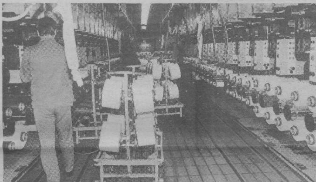
Navijanje poliamidnih nitk (Foto: D. J.)
